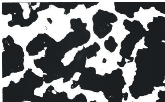
Рис. 1. Микроструктура поверхности шлифа используемого имплантата из пористого никелида титана (X75)
