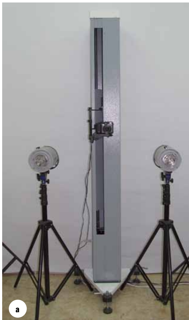
Рис. 1. Экспериментальный образец автоматизированной системы скрининга пигментных новообразований кожи «Паспорт кожи»: а – регистрирующая система (цифровая фотокамера, устройство автоматизированного позиционирования, осветительная система); б – мобильное рабочее место врача
