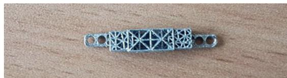
Рис. 2. Титановый имплантат центральная часть балочная 600–800 и 600–1000 мкм
